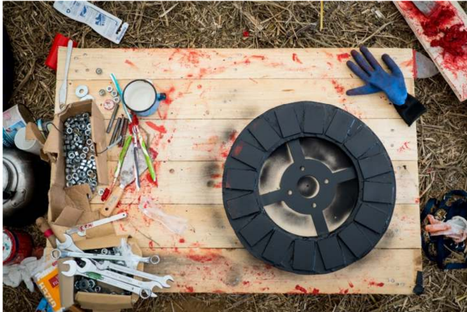
ABBILDUNG 2: ROTORSCHIBE MIT MAGNETEN FÜR DEN GENERATOR
